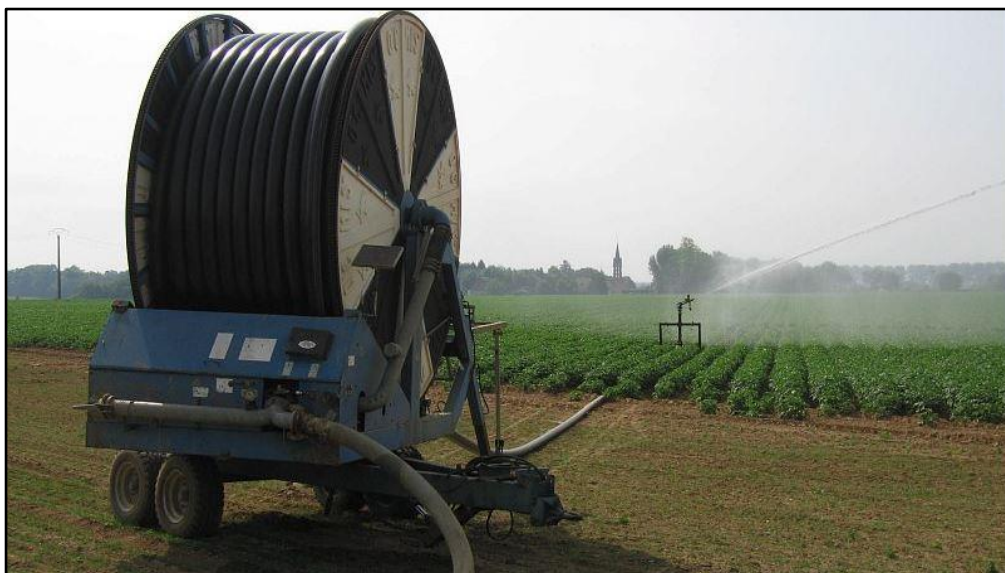
Figure 9 : Canon enrouleur utilisé pour irriguer un champ de pommes de terre. (ARVALIS)
