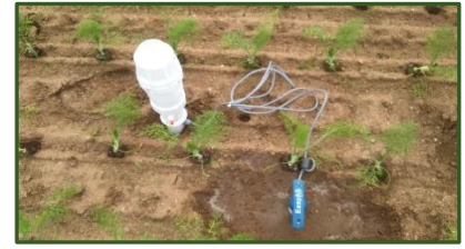
Pilotage de l'irrigation avec sonde capacitive
